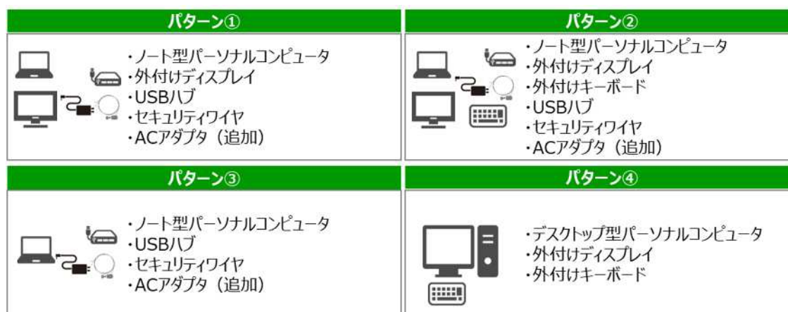
図 3-1：PC 機器等の接続構成パターン
